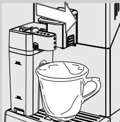
**2** Povlecite pipo za točenje v vrč proti desni do simbola "▲". Pod pipo za točenje postavite skodelico.
