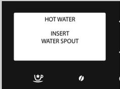
**6** 이 아이콘이 표시됩니다. 기기에 물 음료 추출구를 설치하라는 메시지가 표시됩니다. 물 음료 추출구가 올바르게 설치되어 있는지 확인하십시오. "✓" 버튼을 눌러 확인합니다. 커피 머신이 뜨거운 물을 추출하기 시작합니다.
