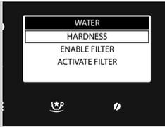
HARDNESS에서는 물 경도 수준을 설정할 수 있습니다. 물 경도 측정에 대해서는 "물 경도 측정 및 프로그래밍" 장을 참조하십시오.
