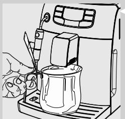
**1** Pod pipo za točenje postavite posodo (pribl. 250 cc).
