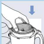
**4** 将过滤组件放入榨汁组件中，让过滤组件外围边沿的3个凸出部分与榨汁组件上的狭槽扣上。
