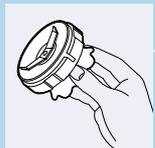
**2** 抓住安全圈，提起刀叶装置。
