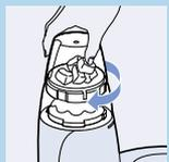
**4** 将组装好的干磨器颠倒过来，取下马达保护盖，并旋在马达装置上。
