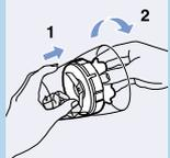
**5** 将安全圈轻轻向外拉出，然后逆时针转动，将刀叶装置从干磨器中取出来。
