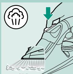
Силната ударна концентрирана парна струя помага за премахване на упорити гънки. Насочената право напред сила парна струя подобрява разпределението на парата във всяка част от дрехата ви. Функцията парен удар може да се използва само при температурни настройки между ●● и MAX.
