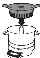
**3** Coloque los ingredientes que desee preparar en la cesta de vapor, el complemento para pasta y/o la bandeja de vapor. Coloque la cesta de vapor, el complemento para pasta y/o la bandeja de vapor en su lugar.
