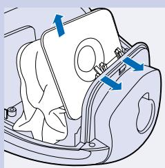
**5** 将集尘袋插入集尘袋舱中，方法是将集尘袋正面的塑料片或纸板片滑动到集尘袋固定架上的狭槽中。尽量向下按。
