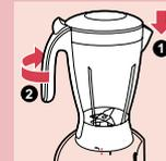
**2** Monten la jarra batidora en la parte superior de la unidad motora haciéndola girar en la dirección de la flecha hasta que quede firmemente fijada. El asa debe quedar mirando hacia la izquierda.
