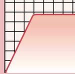
Cihaz 10 saniye içerisinde hızını yavaş yavaş maksimuma arttıracaktır. "Stop" durdurma düğmesine basıncaya kadar cihaz bu hızda çalışmaya devam edecektir. Hız - sembolü düğmeye 3 kez basılarak azaltılabilir ve + sembolü düğmeye 3 kez basılarak artırılabilir. Eğer +/- sembolü düğmeler basıyor ve bir reaksiyon verilmiyorsa ya zaten cihaz en çok limitte veya en az limitte çalışmaktadır.
