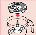
**▷** Βάλτε τα εξαρτήματα (λεπίδα, στήριγμα ένθετων δίσκων) στο στήριγμα εξαρτημάτων και αποθηκεύστε τα στο μπολ. Πάνω να βάζετε πάντα το στήριγμα ένθετων δίσκων.
