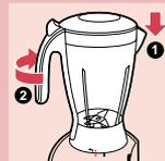
**2** Coloque o copo sobre a unidade do motor, rodando na direcção da seta até ficar firme. A pega deve ficar virada para a esquerda.
