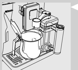
**9** Stavite neku posudu dovoljnog kapaciteta (1,5 l) ispod bloka za ispuštanje. Otvorite blok za ispuštanje mleka okrećući ga u smeru okretanja kazaljki na satu.
