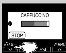
**8** Po okončanju ispuštanja mlečne pene aparat ispušta mleko. Moguće je unapred prekinuti ispuštanje pritiskom na taster "V/-".
