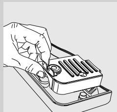
**4** Izvucite podlogu ispod rešetke. Operite podlogu i posudu za kapanje.
