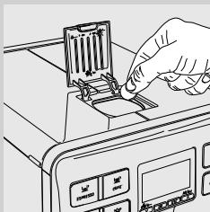
**5** U odeljak za prethodno samlevenu kafu stavite jednu tabletu za odmašćivanje. Pritisnite taster "OK".
