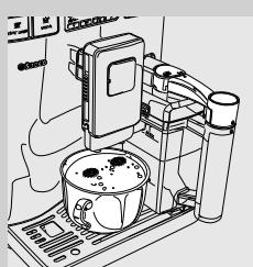
**9** Uklonite šolju i zatvorite blok za ispuštanje mleka okrećući ga u smeru suprotnom od kretanja kazaljki na satu.
