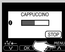
**7** Kada aparat pokaže sledeći ekran, ispuštanje mlečne pene je u toku. Moguće je unapred prekinuti ispuštanje pritiskom na taster "MENU".
