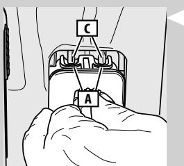
U ovoj fazi, otvor na bloku za ispuštanje (A) nalaze se niže od priključaka (C). Osovinice bloka za ispuštanje su na istoj visini kao i vođice.
