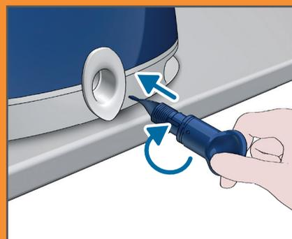
Quando non fuoriesce più acqua dal ferro con generatore di vapore, reinserisci la manopola EASY DE-CALC e ruotala in senso orario per fissarla.
