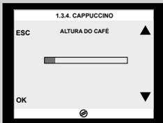
Ao ajustar a barra no visor através das teclas de deslocamento “▼” ou “▲”, é possível seleccionar a quantidade de água para a distribuição de café. Pressione “OK” para confirmar o ajuste.
