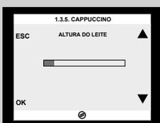
Ao ajustar a barra no visor através das teclas de deslocamento “▼” ou “▲”, é possível seleccionar a quantidade de leite a utilizar para a bebida seleccionada. Pressione “OK” para confirmar o ajuste.
