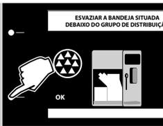
**10** Esvazie a bandeja de limpeza (interior) e volte a introduzi-la na devida posição. Em seguida, pressione a tecla "OK".
