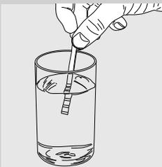
**1** Mergulhe na água, durante 1 segundo, o papel de teste da dureza da água, fornecido com a máquina.
