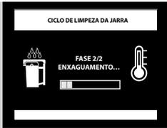
**16** A máquina começa a distribuir água tanto do distribuidor de café como do distribuidor de leite. A barra permite visualizar o estado de avanço do ciclo.
