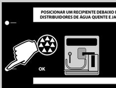
**12** Esvazie o recipiente e coloque-o sob o tubo de vapor/água quente e sob o distribuidor de leite da jarra. Pressione a tecla "OK".
