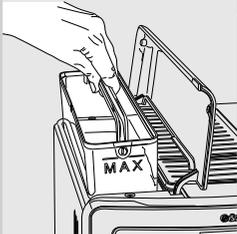
**6** Extraia o reservatório de água utilizando a pega.
