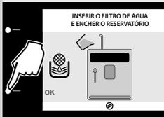
**12** Pressione a tecla "OK" para confirmar a inserção do filtro de água e o enchimento do reservatório.
