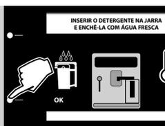
**10** Pressione a tecla "OK" para iniciar o ciclo. A máquina começa a distribuir a solução através do distribuidor de leite.
