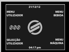
**14** Quando toda a água necessária para o ciclo de enxágúe for distribuída, a máquina termina automaticamente o processo de descalcificação e mostra este ecrã depois de uma breve fase de aquecimento.
