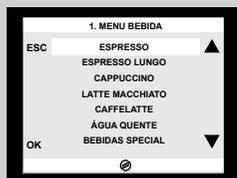
**2** Pressione as teclas de deslocamento **"▼"** ou **"▲"** e confirme com **"OK"** para seleccionar a bebida.
