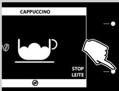
7 Quando for visualizado o ecrã ao lado, a máquina inicia a distribuição de espuma de leite. Para interromper a distribuição antecipadamente, pressione a tecla “**STOP LEITE**”.
