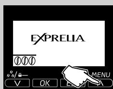
**4** Od ovog trenutka moguće je programirati postavke tvrdoće vode. Pritisnite taster "MENU" za pristup glavnom meniju aparata.
