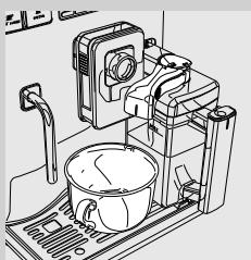
**1** Umetnите posudu za mleko i postavite šolju ispod bloka za ispuštanje. Otvorite blok za ispuštanje mleka okrećući ga u smeru okretanja kazaljki na satu.
