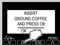
**6** Pritisnite "OK" za potvrdu i početak ispuštanja.
