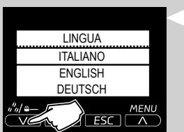
**13** Pojavljuje se sledeći prikaz na ekranu. Odaberite željeni jezik pritiskom na tastere za prelistavanje "V" ili "A".
