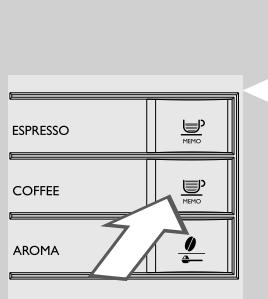
**7** Prikazuje se simbol na strani. Aparat pokazuje da instalirate blok za ispuštanje vode. Proverite da li je blok za ispuštanje vode pravilno instaliran. Pritisnite da biste to potvrdili. Aparat počinje da ispušta toplu vodu.
