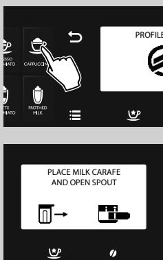
**3** Držite pritisnut taster za kapućino "CAPPUCCINO" sve dok se ne prikaže displej pored, a onda pustite taster. Aparat vas podseća da je potrebno umetnuti posudu i izvaditi blok za ispuštanje na posudi. Od ovog trenutka, aparat je u fazi programiranja.
