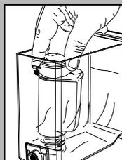
**i** Remarque : après avoir complété le cycle de détartrage, il est possible de réinstaller le filtre « Intenza » qui avait été enlevé du réservoir à eau au début du cycle. Une fois le filtre installé, avant la distribution d'un café, distribuer une tasse d'eau à travers la fonction « Distribution d'eau chaude » (voir la section « Distribution d'eau chaude »).
