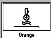
**i** **Une fois la phase de réchauffage terminée, la machine effectue un cycle de rinçage des circuits internes. Maintenant le symbole s'affiche sur l'afficheur.**
