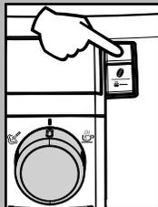
Appuyer sur la touche ON/OFF pour mettre la machine en Stand-by.
