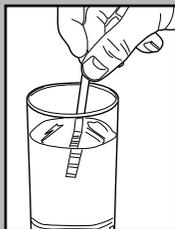
Plonger dans l'eau la bande de test fournie avec la machine pendant une seconde, afin de vérifier la dureté de l'eau.
