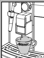
Pour effectuer ce réglage, lever ou baisser la buse de distribution manuellement plaçant les doigts comme montré dans la figure.
