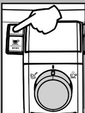
• Appuyer sur la touche «
