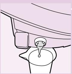
**5** 清空蒸氣槽，將蒸氣槽中的水倒入杯中或水槽中。
