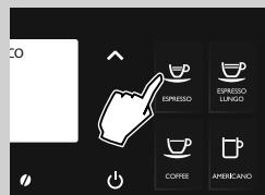
**9** Ispuštanje kafe se automatski prekida kada se postigne prethodno određeni nivo; ipak ga je moguće unapred prekinuti ponovnim pritiskanjem tastera odabranog napitka.
