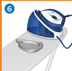
Coloque el depósito Calc-Clean sobre la tabla de planchar o cualquier otra superficie uniforme y estable.
