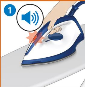
Realice el proceso de eliminación de la cal en cuanto el piloto Calc-Clean empiece a parpadear y el aparato emita un pitido de forma continua.
