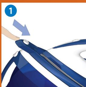
1 Coloque la plancha en la base y presione el bloqueo de transporte para bloquear la plancha en su sitio.
