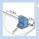
2 将底座放在靠墙的水平地板上。
