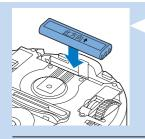
3 将新充电电池装入电池仓,将电池仓盖滑入智能自动真空吸尘器。
