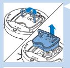
2 上拉集尘桶盖手柄,从集尘桶仓中提出集尘桶。 注意: 取下或重新插入集尘桶时, 小心不要损坏马达 风扇的刀片。
