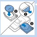
2 从电池仓中取出电量耗尽的电池,装入新电池。 然后将电池仓滑入遥控器。
