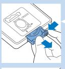
遥控器由 CR2025 纽扣电池供电。按遥控器上的按钮,智能自动真空吸尘器不再响应时,请更换电池。
