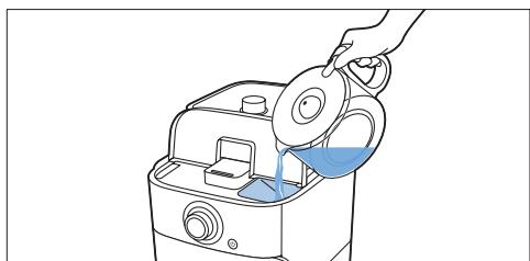
Відкривши кришку резервуара для води, на внутрішній частині пристрою можна побачити позначки від 2 до 10 філіжанок. За допомогою цих позначок можна визначити кількість води у резервуарі.
