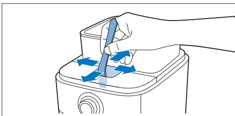
3 将滤纸(4号)放入滤框并关闭滤框支架。
