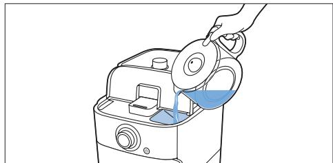
Når du åpner lokket på vannbeholderen, er det indikatorer for 2 til 10 kopper på innsiden av apparatet. Du kan bruke disse indikatorene for å bestemme hvor mye vann du skal ha i vannbeholderen.
