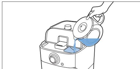
Når du åbner låget til vandtanken, er der markeringer for 2 til 10 kopper på indersiden af apparatet. Du kan bruge disse markeringer til at bestemme, hvor meget vand du vil putte i vandtanken.
