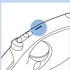
A função de desactivação automática de segurança desliga automaticamente o ferro, no caso de este não ser utilizado durante 30 segundos quando está pousado sobre a base ou durante 8 minutos quando está pousado sobre a placa posterior. A luz da desactivação automática acende-se.
