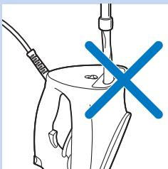
Non versare acqua, aceto, anticalcare o altre sostanze chimiche nel ferro attraverso l'apertura del Sistema rapido di pulizia anticalcare.
