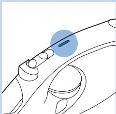
Questa funzione consente di spegnere automaticamente l'apparecchio dopo 30 secondi di immobilità in posizione orizzontale o 8 minuti di immobilità in posizione verticale. La spia dello spegnimento automatico si illumina.
