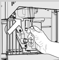
**5** 使用咖啡機提供的特殊清潔工具，或者使用湯匙柄徹底清潔咖啡排出通道。請確認您如圖所示的方式插入清潔工具。
