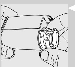
**3** 根據濾水器底座指示及進行的測量（請參閱上一章節）設定「INTENZA+」濾水器：
