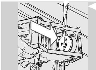
**7** 用溫水徹底清洗沖煮系統，仔細地清洗上部的濾水器。
