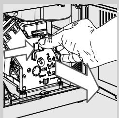
**21** 除垢程式結束時，如「沖煮系統的每週清潔」章節中所描述一般清洗沖煮系統。
