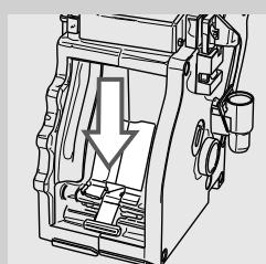
**11** 輕輕拉下控制桿，直到它接觸沖煮系統底座，與兩個在沖煮系統旁的參考標誌匹配為止。
