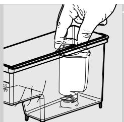
**20** 取出白色小濾水器，並更換水箱中的「INTENZA+」濾水器（若已安裝）。沖洗後，將乾淨的水加到 MAX（最大）刻度線。將其放回咖啡機。
