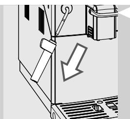
**2** 從蒸汽/熱水管中取出經典發泡器。
