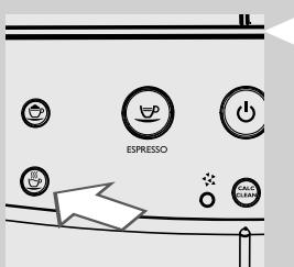
**3** Pritisnite taster "☕" da biste pokrenuli ispuštanje tople vode; taster "☕" trepće tokom cele faze pripreme i ispuštanja.
