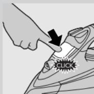
**5** Stäng locket till påfyllningsöppningen ("klick").
