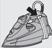
**1** Rul ledningen rundt om oprulningsfunktionen, og sæt den fast med ledningsklemmen.
