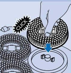
**7** Fije los cepillos o los fieltros en la parte inferior. Asegúrese de presionar hasta escuchar el "click", para verificar que estén correctamente colocados.
