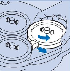
**6** Saque los dos protectores metálicos de los rodillos, girando con la mano los cepillos (fig. 6). No vuelva a colocar los protectores.
