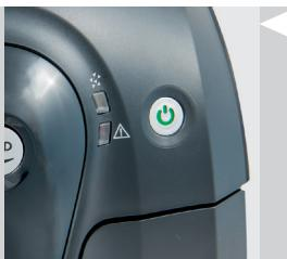
4 Led lampica "⊕" svijetli stalno. Aparat je spremam za ispuštanje kave.
