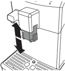
Mit der Maschine können verschiedene Kaffeespezialitäten in Tassen oder Gläsern unterschiedlicher Größe zubereitet werden. Um die Höhe des Kaffeeauslauftrichters auf die Größe der Tasse oder des Glases einzustellen, schieben Sie den Auslauf nach oben oder unten.
