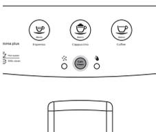
Die Anzeige CALC-CLEAN (Entkalken) leuchtet ununterbrochen, wenn die Kaffeemaschine entkalkt werden muss. Wenn Sie die Maschine nicht entkalken, wenn diese Taste dies anzeigt, hört die Maschine auf, richtig zu funktionieren. Reparaturen, die hierauf zurückzuführen sind, fallen nicht unter die Garantie.
