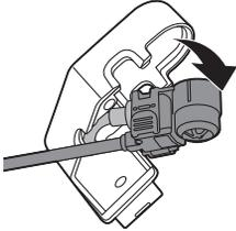
2 Trennen Sie den unteren Teil vom automatischen Milchaufschäumer ab.
