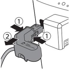
1 Entfernen Sie den automatischen Milchaufschäumer von der Maschine.
