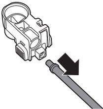
5 Entfernen Sie den Schlauch mit dem Anschlussstück.
