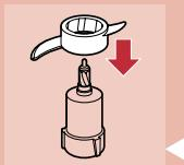
Der Knetaufsatz kann zum Kneten von Brotteig oder Klößen und zum Mischen von Kuchenteig verwendet werden.
