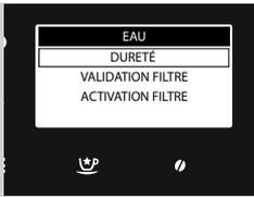
Dans **DURETÉ** il est possible de régler le degré de dureté de l'eau. Pour mesurer la dureté de l'eau, consulter le chapitre « Mesure et programmation de la dureté de l'eau ».
