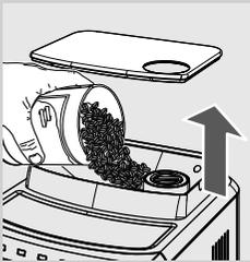
**8** Enlever le couvercle du réservoir à café en grains et verser lentement le café en grains dans le réservoir.
