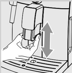
Pour effectuer ce réglage, soulever ou baisser la buse de distribution du café manuellement, en plaçant les doigts comme le montre la figure.
