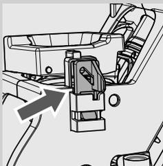
**11** S'assurer que le crochet pour le blocage du groupe de distribution est dans la bonne position ; pour ce faire, appuyer fermement sur la touche « PUSH » jusqu'à l'enclenchement. Veiller à ce que le crochet soit en haut à la butée. Dans le cas contraire, essayer à nouveau.
