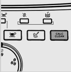
Le calcaire qui se forme à l'intérieur de la machine au cours de l'utilisation doit être éliminé régulièrement ; dans le cas contraire, le circuit hydraulique et du café peuvent se boucher. La machine signalera quand il sera nécessaire de procéder au détartrage. Si la DEL « **CALC CLEAN** » est allumée fixe cela signifie qu'il est nécessaire de procéder au détartrage.
