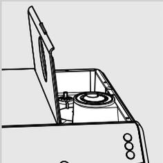
Vsebnik za kavo v zrnju očistite enkrat na mesec z vlažno krpo, kadar je prazen in odstranite oljne snovi kave. Nato ga ponovno napolnite s kavo v zrnju.
