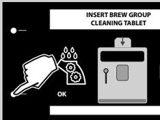
**5** Stavite tabletu za odmašćivanje u odeljak za prethodno samlevenu kafu. Pritisnite taster "OK".
