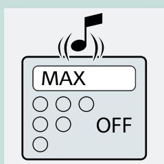
**4** Valitse silityslämpötila painamalla lämpötilavalintapainiketta +. Lyhyt merkkiäni ilmoittaa, että lämpötila-asetusta on muutettu.
