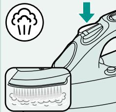
Un potente chorro de vapor ayuda a eliminar las arrugas persistentes. La función supervapor sólo se puede usar a una temperatura entre ●● y la temperatura máxima.
