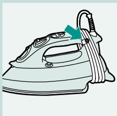
**4** Enrolle el cable de red alrededor del dispositivo recogecable.
