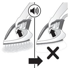
Além disso, existe um segundo passo integrado para proteger o gerador de vapor do calcário: a função de vapor é desativada se a descalcificação não for efetuada. Após a descalcificação, a função de vapor será restaurada. Isto acontece independentemente do tipo de água utilizado.
