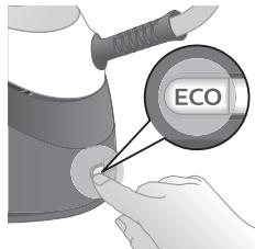
Ao utilizar o modo ECO (quantidade reduzida de vapor), pode economizar energia sem comprometer o resultado do engomar.
