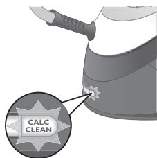
Na 1 tot 3 maanden gebruik begint het Calc-Clean-lampje te knipperen en gaat het apparaat piepen om aan te geven dat u de Calc-Clean-procedure moet uitvoeren.
