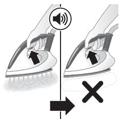
Bovendien is er een tweede voorziening in het apparaat geïntegreerd om de stoomgenerator te beschermen tegen kalk: de stoomfunctie wordt uitgeschakeld als het apparaat niet wordt ontkalkt. Nadat de ontkalkingsprocedure is uitgevoerd, wordt de stoomfunctie weer ingeschakeld. Dit gebeurt ongeacht het gebruikte type water.
