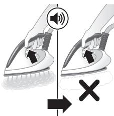
Además de eso, se incorpora un segundo paso para proteger el generador de vapor de la escala: la función de vapor se inhabilita si no se elimina la cal. Una vez eliminada la cal, se restaura la función de vapor. Esto ocurre con independencia del agua empleada.
