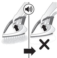
Därutöver finns det ytterligare en skyddsåtgärd som skyddar ånggeneratorn mot kalkavlagringar: ångfunktionen stängs av om ingen avkalkning utförs. Efter avkalkning återställs ångfunktionen. Detta sker oavsett vilken typ av vatten som används.
