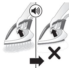
Inoltre, è integrato un altro livello di difesa per proteggere il generatore di vapore dal calcare: la funzione di vapore viene disabilitata se non viene effettuata la rimozione del calcare. Al completamento della rimozione del calcare, la funzione di vapore verrà ripristinato. Ciò si verifica a prescindere dal tipo di acqua utilizzata.
