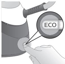
Genom att använda ECO-läget (reducerad mängd ånga) kan du spara energi utan att försämra strykresultatet.
