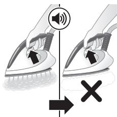
Außerdem ist zum Schutz des Dampfgenerators vor Kalk ein zweiter Abwehrschritt integriert: die Dampffunktion wird deaktiviert, wenn das Gerät nicht entkalkt wird. Nach dem Entkalken ist die Dampffunktion wieder einsatzbereit. Das geschieht unabhängig vom genutzten Wassertyp.
