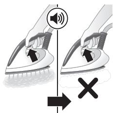
นอกจากนี้แล้ว ยังมีการป้องกันขันที่สองเพื่อบังกันตะกรันจับเครื่องทำไอน้ำ ดังนี้ พังก์ขัน ไอน้ำจะปิดการทำงาน หากไม่มีการขัดคราบตะกรัน หลังจากล้างสุดการขัดคราบตะกรัน พังก์ขัน ไอน้ำจะถูกเปิดใช้งานอีกรอบ โดยไม่คำนึงถึงประเภทของน้ำที่ใช้
