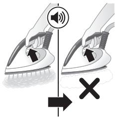
나아가 두 번째 보호 단계로 스팀 시스템 다리미에 석회질이 쌓이는 것을 방지합니다. 석회질 제거를 수행하지 않으면 스팀 기능이 작동하지 않게 됩니다. 석회질 제거를 마치면 스팀 기능은 회복됩니다. 이는 사용한 물 종류에 상관없이 동일하게 작동합니다.
