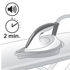
5 在除垢流程中，您将听到短暂的蜂鸣音和抽水声。
