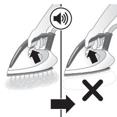
除此之外，还整合了次级保护步骤，能够保护蒸汽发生器，避免水垢积聚：如果没有进行除垢，将禁用蒸汽功能。除垢完成后，蒸汽功能将会恢复。无论使用哪种类型的水，这种情况都会出现。
