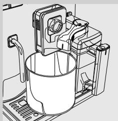
**15** Опорожните емкость и снова установите ее под устройство подачи кофе. Откройте устройство подачи молока, повернув его по часовой стрелке.
