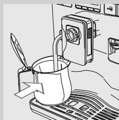
5 По завершении подачи опорожните емкость и снова установите ее под трубку пара/горячей воды.
