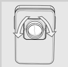
Система Saeco Brewing System (SBS) позволяет контролировать образование кремовой пенки и интенсивность вкуса кофе, регулируя скорость вытекания кофе во время цикла подачи.
