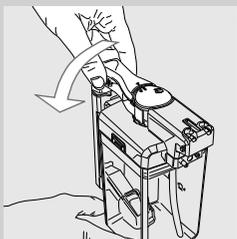
**7** Установите устройство подачи молока в положение блокировки, повернув его против часовой стрелки.
