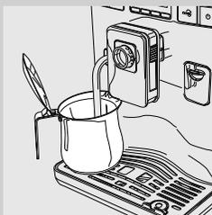
1 Установите емкость под трубку пара/горячей воды.
