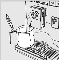
**6** Установите вместительную емкость (1,5 л) под трубку пара / горячей воды.
