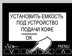
**6** Установите емкость (1,5 л) под устройство подачи кофе. Нажмите кнопку "OK" для включения цикла очистки.
