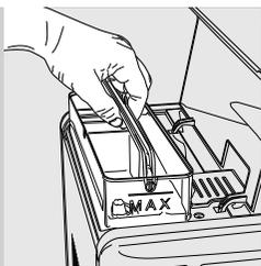
**5** Поднимите крышку и извлеките бак для воды, пользуясь ручкой.
