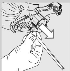
**7** Снимите всасывающую трубку.
