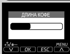
Регулируйте полосу на дисплее с помощью кнопок прокрутки "V" или "Λ", можно выбрать количество воды для подачи кофе. Нажмите кнопку OK для подтверждения настройки.
