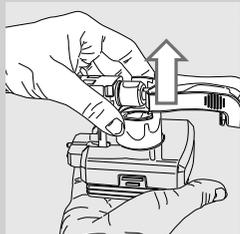
**6** Извлеките ручку со всасывающей трубкой.
