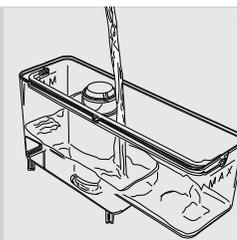
**5** Наполните бак свежей водой до уровня MAX и вставьте его обратно в машину.
