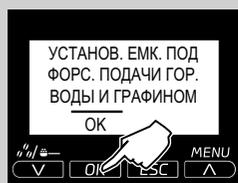
**12** Опорожните емкость и установите ее обратно под трубку пара / горячей воды и под устройство подачи молока графина. Нажмите кнопку "OK".
