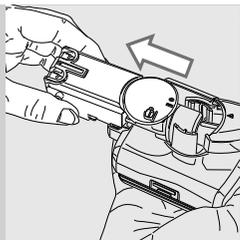
**5** Извлеките соединитель, соединяемый с машиной.
