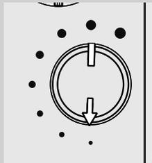
**2** Нажмите и поверните ручку регулировки помола только на одно деление за раз. Разница вкуса будет ощутимой после подачи 2-3 эспрессо.
