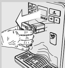
**6** Извлеките устройство подачи и вымойте его водой.
