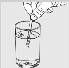
**1** Погрузите в воду на 1 секунду образец для теста жесткости воды, входящий в комплект поставки машины.
