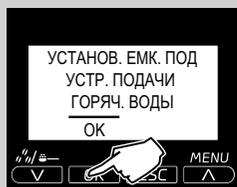
**13** Нажмите кнопку "OK", чтобы подтвердить наличие емкости под устройством подачи воды.
