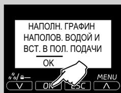
**11** Опорожните графин для молока и наполните его свежей водой. Вставьте его обратно в машину. Нажмите кнопку "OK".
