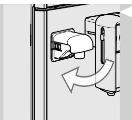
**2** Pipo za točenje vode pritisnite in obrnite navzdol, dokler se ne spoji z aparatom, kot prikazuje slika.
