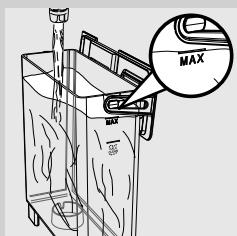
**7** Rezervoar splaknite s tekočo vodo.
