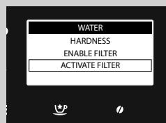
**V ACTIVATE FILTER** se izvede aktiviranje filtra po njegovi namestitvi ali zamenjavi. Glejte poglavje "Namestitev filtra vode INTENZA+".
