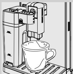
**2** Povlecite pipo za točenje v vrč proti desni do simbola "▲". Pod pipo za točenje v vrč postavite skodelico.
