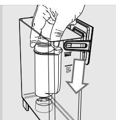
**11** Filter vode "INTENZA+" vstavite v prazen rezervoar za vodo. Potisnite ga kolikor gre navzdol.
