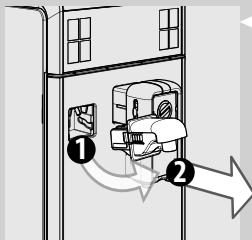
**1** Če je nameščena, pipo za točenje vode odstranite, kot je prikazano na sliki:
