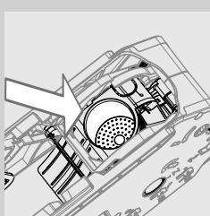
**9** Sklop za kavo skrbno operite z mlačno vodo in skrbno očistite filter sklopa za kavo.
