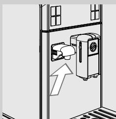
**14** Preverite, da je pipa za točenje vode pravilno nameščena.
