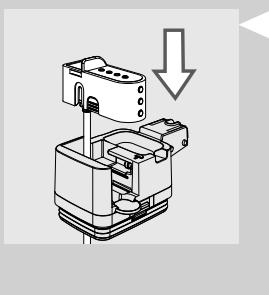
**6** Po namestitvi sesalne cevi s priključkom, v zgornji del vrča vstavite pipo za točenje v vrč.
