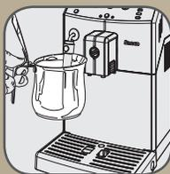
Placez un récipient sous la buse de vapeur. Les voyants “⚠” et “⚠” clignotent simultanément, puis la touche “☕” s'allume. Pour amorcer le circuit, appuyez sur la touche “☕”. La machine se réchauffe; les touches “☕” et “☕” clignotent simultanément. Attendez la fin du cycle automatique.
