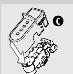
6 藉由輕輕按壓側面同時向下拉，從鮮奶壺釋水管上拆下蓋子 (C)。
