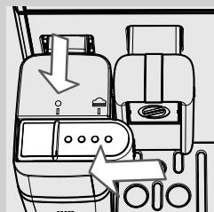
**11** 將鮮奶壺釋水管放回原位，向上捲動至「●」圖示處。
