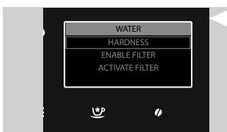
在「**HARDNESS**」（硬度）下，可設定水質硬度等級。
