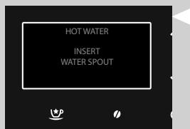
**6** 顯示此圖示。咖啡機會提醒您安裝釋水咖啡龍頭。檢查確保釋水咖啡龍頭已正確安裝。按下「」確認。咖啡機將開始釋出熱水。
