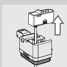
**3** 拉起咖啡龍頭，將其從壺頂部取下。鮮奶壺釋水管由五個必須可拆卸的零件組成。每個零件均用大寫字母標識（A、B、C、D、E），如下圖所示。
