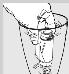
**1** 從包裝中取出「INTENZA+」濾水器，垂直浸泡在冷水中（開口朝上），輕按兩側以排出氣泡。
