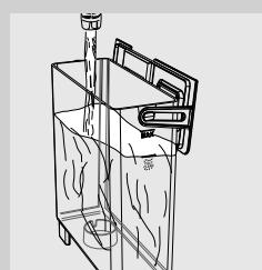
**7** 注入乾淨的水到水箱中，直到 CALC CLEAN 刻度。
