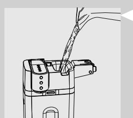
**2** 將鮮奶倒入鮮奶壺中：鮮奶水平必須介於鮮奶壺上所示 MIN（最小）與 MAX（最大）刻度標記之間。將鮮奶壺蓋子蓋回原處。
