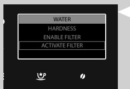
安裝或更換完成后，在「**ACTIVATE FILTER**」（啟動濾水器）下啟動濾水器。請參閱「INTENZA+ 濾水器安裝」章節。
