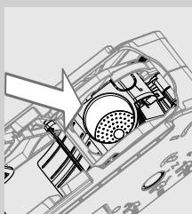
**7** 用溫水徹底清洗沖煮系統，仔細地清洗沖煮系統濾水器。
