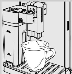
**2** 將鮮奶壺釋水管向右拔出至「
