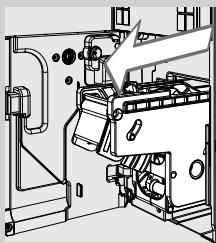
**6** 拉動調節桿時，取出沖煮系統。
