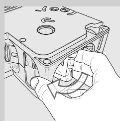
**12** 手動關閉底座上的銷扣，將沖煮系統轉回至關閉位置，如此圖所示。旋轉此系統，直至鎖定到下一步驟中所述的位置。
