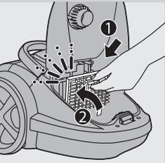
**3** Setzen Sie den neuen Filter wieder in den Filterhalter. Die beiden Vorsprünge müssen unten so hinter die Rippe gesteckt werden, dass der Filterhalter oben einwandfrei sitzt (1). Drücken Sie ihn dann fest, bis er hörbar einrastet (2).
