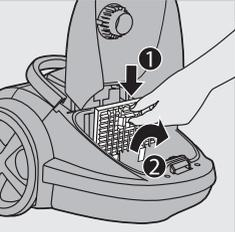
**2** Drücken Sie die Entriegelungstaste (1) und nehmen Sie den Motorschutzfilter-Halter aus dem Gerät (2). Nehmen Sie den Motorschutzfilter aus dem Filterhalter.
