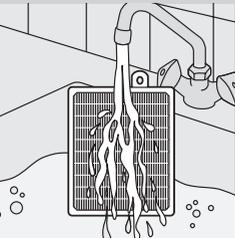
1 Spülen Sie den HEPA-13-Filter unter heißem, langsam fließendem Wasser ab.
