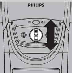
Sie können die Saugleistung während des Staubsaugens mit dem Saugleistungsregler auf dem Gerät einstellen.
