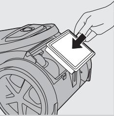
**3** Setzen Sie den neuen Filter in das Gerät ein.
