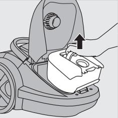
**1** Nehmen Sie den Staubbeutelhalter mit dem Staubbeutel aus dem Gerät.
