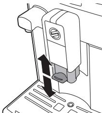
本咖啡機可用來沖煮不同種類的咖啡，容器可以是不同尺寸的杯子或玻璃杯。若要調整咖啡流出口的高度至杯子或玻璃杯尺寸適合的位置，請向上或向下滑動流出口。
