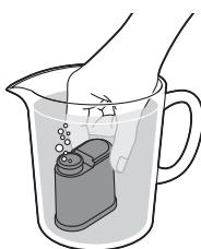
20 將 AquaClean 濾水器上下顛倒放置在裝有冷水的容器中，直到氣泡不再冒出來為止。
