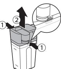
1 按下牛奶罐頂端兩側的釋放按鈕 (1)，掀開牛奶罐的頂部 (2)。
