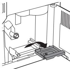
8 移除並清空咖啡粉殘渣槽後，在水龍頭下以溫水沖洗。晾乾後重新插入。
