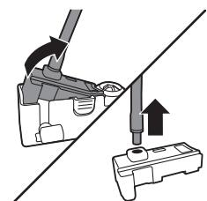
2 將流出口蓋上下顛倒並拿穩。從橡膠支撑架中拔出吸塵管。
