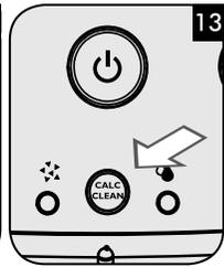
В края на цикъла на измиване бутонът угазва.
