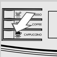
**3** Držite pritisnutu tipku "CAPPUCINO" dok se na zaslonu ne prikaže simbol "MEMO", zatim pustite tipku. Aparat je sada u fazi programiranja.
