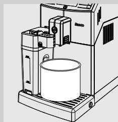
**16** Vrč za mlijeko ugradite u aparat. Izvucite ispust vrča udesno sve do simbola "▲". Vratite posudu ispod ispusta vrča za mlijeko i ispod ispusta kave.
