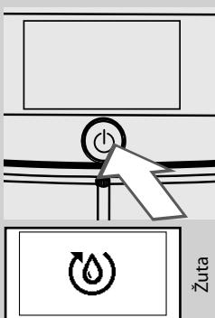
**13** Za uključivanje aparata dovoljno je pritisnuti tipku "O". Aparat nastavlja s automatskim punjenjem sustava.
