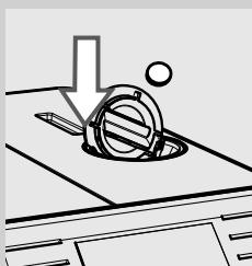
**3** Ubacite jednu tabletu za odmašćivanje u odjeljak za prethodno samljenu kavu.
