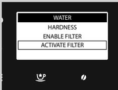
U **ACTIVATE FILTER** izvršava se aktiviranje filtera nakon njegove ugradnje ili izmene. Pogledajte poglavlje "Ugradnja filtera za vodu INTENZA+".
