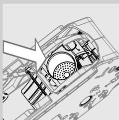
**9** Dobro operite blok za pripremu kafe svežom mlakom vodom; pažljivo očistite filter bloka za pripremu kafe.
