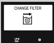
Aparat signalizuje potrebu zamene filtera za vodu "INTENZA+".
