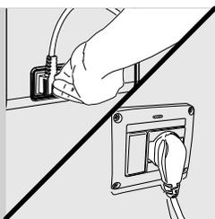
**11** Utaknite utikač u utičnicu za struju smeštenu na poledini aparata.
