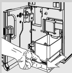
**5** Uklonite posudu za kapanje (unutrašnju) i posudu za sakupljanje taloga i očistite ih.
