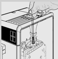
**3** Četkicom za čišćenje dobro očistite odeljak za prethodno samlevenu kafu, uverivši se da više nema ostataka kafe u cevovodu.
