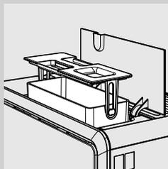
**6** Izvucite rezervoar za vodu pomoću ručice spojene sa unutrašnjim poklopcem.
