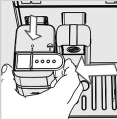
**12** Po okončanju ispuštanja, ako ne želite izvršiti automatski ciklus ispiranja posude, ponovo zatvorite blok za ispuštanje na posudi pustivši ga da klizi do simbola "●".
