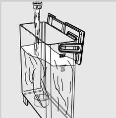
7 Rezervoar napunite svežom vodom sve do nivoa CALC CLEAN. Vratite rezervoar u aparat. Pritisnite taster "✓".
