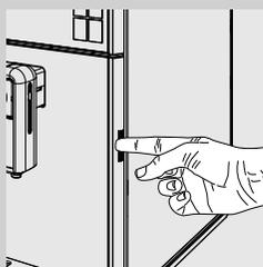
**4** Pritisnite dugme ugrađeno u okvir i otvorite servisna vrata.
