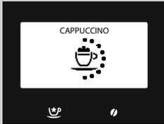
**10** Aparat počinje sa ispuštanjem mleka. Da biste prekinuli ispuštanje ponovo pritisnite taster odabranog napitka, ispuštanje će se završiti nakon nekoliko sekundi.
