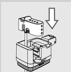
**6** Nakon što instalirate usisnu cev sa spojnicom, umetnite blok za ispuštanje na posudi u gornji deo posude.
