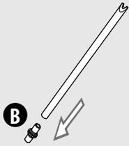
**5** Uklonite spojnicu (B) sa usisne cevi.
