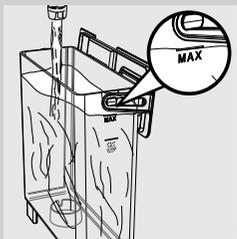
**15** Na kraju, ponovo napunite rezervoar za vodu do nivoa MAX. Sada je aparat spreman za ispuštanje kafe. Prikazaće se simbol naveden na strani.
