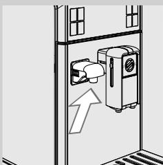
**14** Proverite da li je blok za ispuštanje vode pravilno instaliran.
