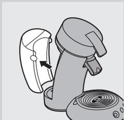
**2** Залейте холодную воду в ёмкость для воды до отметки **MAX** и установите её на кофеварку.
