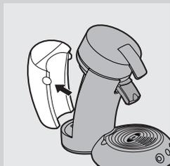
**2** Napelnij zbiornik zimną wodą do poziomu oznaczonego symbolem „MAX” i umieść go ponownie w urządzeniu.
