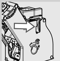
**10** 通过用力按下“PUSH”（压）按钮直到其锁定到位，确保锁定咖啡冲泡器的挂钩位置正确。检查挂钩是否挂到位。如未到位，请重试。
