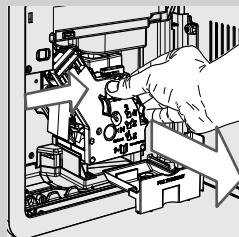
**10** 卸除咖啡粉槽并打开服务门。取下咖啡渣槽，再取下咖啡冲泡器。
