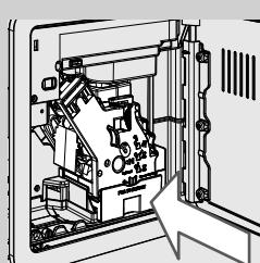
**12** 在清洗完成后，将咖啡冲泡器重新安到底座上，直至锁定到位（参阅“咖啡冲泡器的每周清洁”章节）。插入咖啡渣槽和咖啡粉槽。
