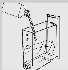
**8** 取下水箱，并将整瓶除垢剂倒入其中。然后将清水注入水箱，直至达到 CALC CLEAN (清除水垢) 水位线。
