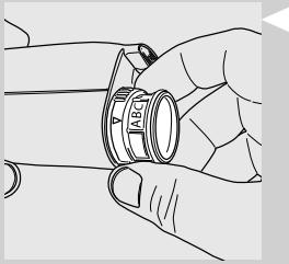
**3** 根据完成的水质测量结果（请参阅上一章节）和滤水器底座上的标注设置“INTENZA+”滤水器：
