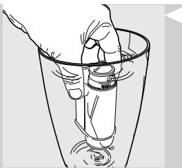
**2** 将“INTENZA+”滤水器从包装中取出，将其竖直浸入冷水中（开口朝上），轻轻按压两侧以排出气体。
