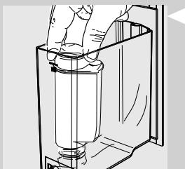
**4** 将“INTENZA+”滤水器插入空水箱。将滤水器按到底，安装到位。
