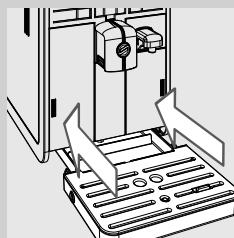
**4** 将带格栅的滴水盘安装至机器上。确保将其完全插入。
