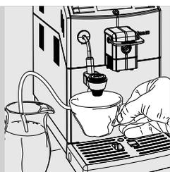
**5** Positionner une tasse sous le Mousseur à lait Automatique.
