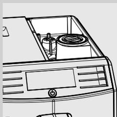
Nettoyer le réservoir à café en grains une fois par mois quand il est vide avec un chiffon humide afin d'éliminer les substances huileuses du café. Le remplir de nouveau avec le café en grains.
