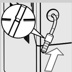
**26** Réinsérer le protecteur en caoutchouc sur la buse de vapeur.
