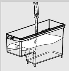
12 Extraire le réservoir à eau, le rincer et le remplir avec de l'eau fraîche jusqu'au niveau MAX. Le réinsérer dans la machine. La page-écran suivante s'affiche lorsque le réservoir à eau est inséré dans la machine.
