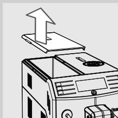
**3** Retirer le couvercle du réservoir à eau.
