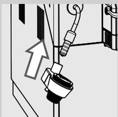
**27** Insérer le Mousseur à lait Automatique sur le protecteur en caoutchouc jusqu'à l'enclenchement.
