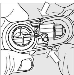
**24** Monter le Mousseur à lait Automatique dans le raccord en s'assurant qu'il est fixé correctement dans son logement.
