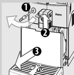
**17** Pour nettoyer le bac d'égouttement, mettre une tablette de dégraissage dans le bac et le remplir pour 2/3 avec de l'eau chaude. Laisser agir la solution de nettoyage pendant 30 minutes environ puis rincer abondamment.
