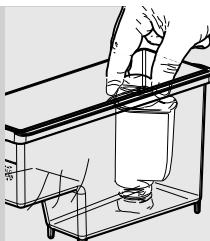
**4** Τοποθετήστε το φίλτρο νερού «INTENZA +» μέσα στο άδειο δοχείο νερού. Σπρώξτε το στο χαμηλότερο δυνατό σημείο.
