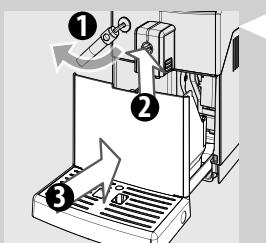
**4** Τοποθετήστε ξανά το δοχείο συλλογής στερεών υπολειμμάτων στον δίσκο συλλογής υγρών και τοποθετήστε τον δίσκο στην μηχανή.
