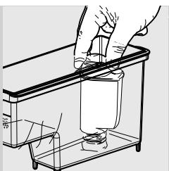
**20** Αφαιρέστε το μικρό λευκό φίλτρο και επανατοποθετήστε το φίλτρο νερού «INTENZA+» (αν έχει εγκατασταθεί) στο δοχείο νερού. Ξεπλύνετε και γεμίστε το με φρέσκο νερό μέχρι τη στάθμη MAX. Επανατοποθετήστε το στη μηχανή.
