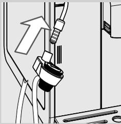
**26** Rimuovere il filtrino bianco e riposizionare il filtro acqua "INTENZA+" (se presente) nel serbatoio dell'acqua e reinserire il Montalatte Automatico.
