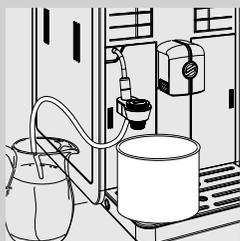
**2** Posizionare un contenitore vuoto sotto il Montalatte Automatico.
