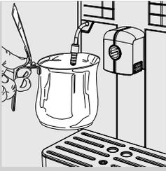
**1** Inserire un contenitore sotto il tubo vapore.
