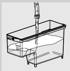
12 Izvadite spremnik vode, isperite ga i napunite svježom vodom do razine MAX. Vratite ga natrag u aparat. Kada se u aparat umetne spremnik vode, prikazuje se sljedeći zaslon.
